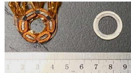
図2 製作した小型化モータ
